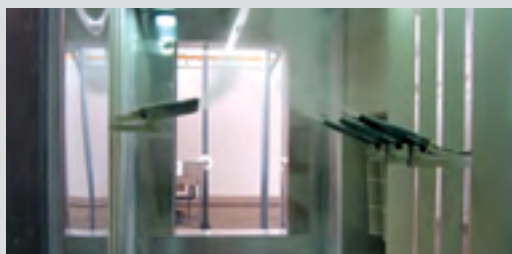
Рис. 5.6. Камера порошковой покраски
