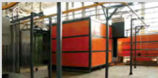
Рис. 5.5. Автоматизированная покрасочная линия
