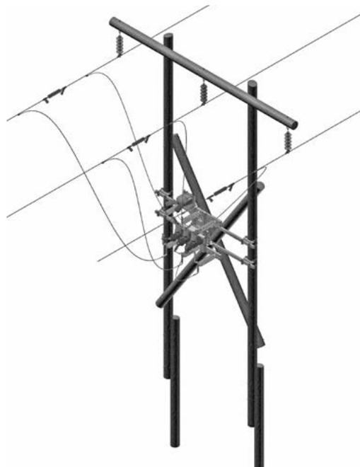
Рис. 8.19. Установка реклоузера на деревянную опору
