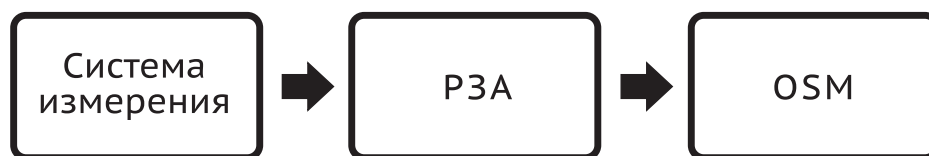
Рис.7.1. Схема прохождения формирования сигналов внутри реклоузера
