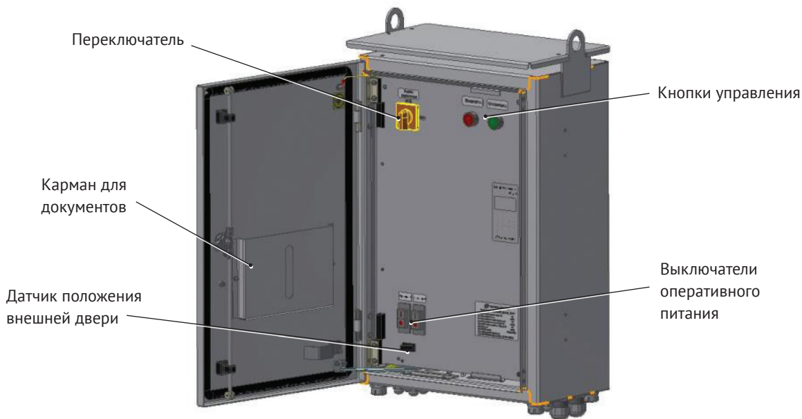
Рис.6.13. Шкаф управления с открытой внешней дверцей
